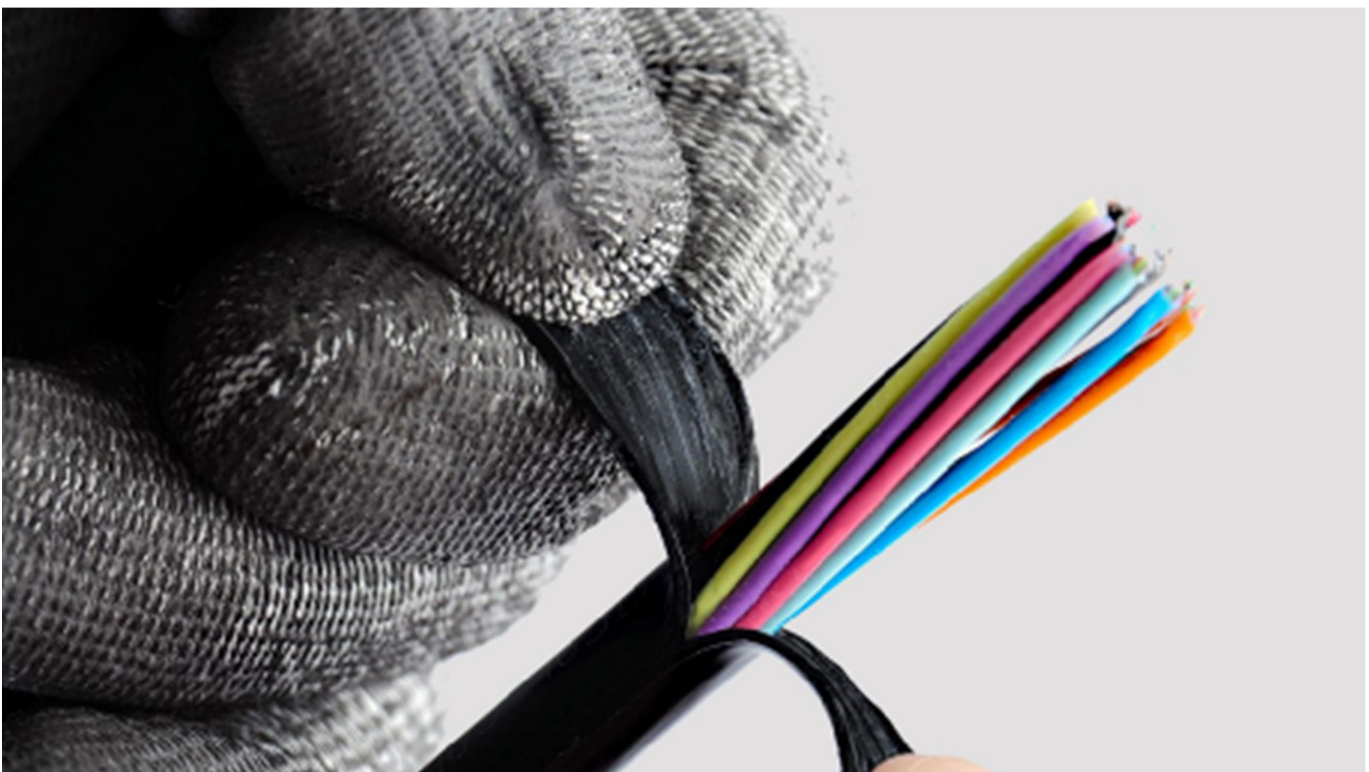
هر سینی اسپلایس دارای ۷۲ اتصال است، بنابراین ترتیب تیوب بافر رنگی و تارهای رنگی برای درست نگه داشتن تمام اتصالات استفاده می‌شود.
